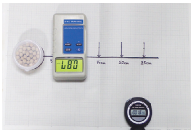
放射性物質のガンマ線強度を測定している様子
