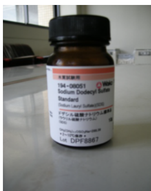
図4 ドデシル硫酸ナトリウム Sodium dodecyl sulfate \text{CH}_3(\text{CH}_2)_{11}\text{OSO}_3\text{Na}
