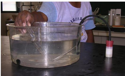
図 14-1 フィルムケース装置を用いて過酸化水素水とジャガイモから、酸素を捕集している実験の様子
