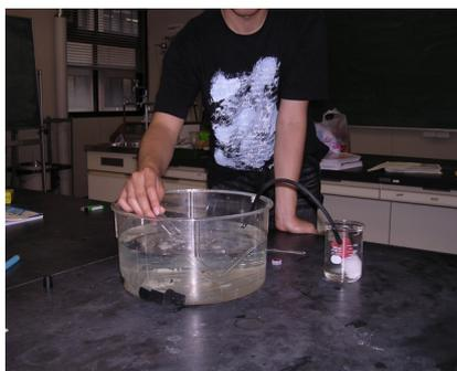
図 9-2 フィルムケース装置を湯の入ったビーカーにつけ、水上置換法で気体を捕集した。
