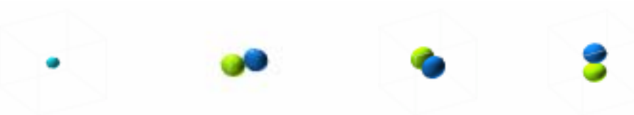
図 6. 3D STRUCTURE OF THE ORBITALS : 3D で表した電子軌道。左から順に , 1s 軌道 , 2px 軌道 , 2py 軌道 , 2pz 軌道。
