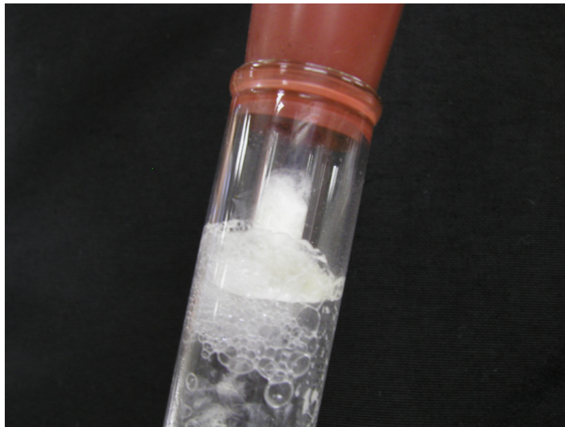
写真5 泡を止めるための工夫（阿波トメール）
