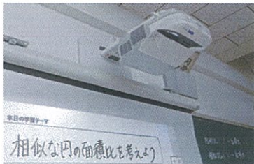
黒板の上の壁に取り付けられたEB-485WT。この位置からスクリーンに映せる。
