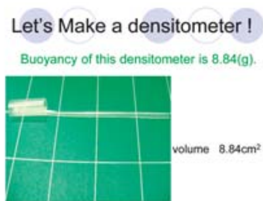
図7. 食塩濃度計のフロートづくり
